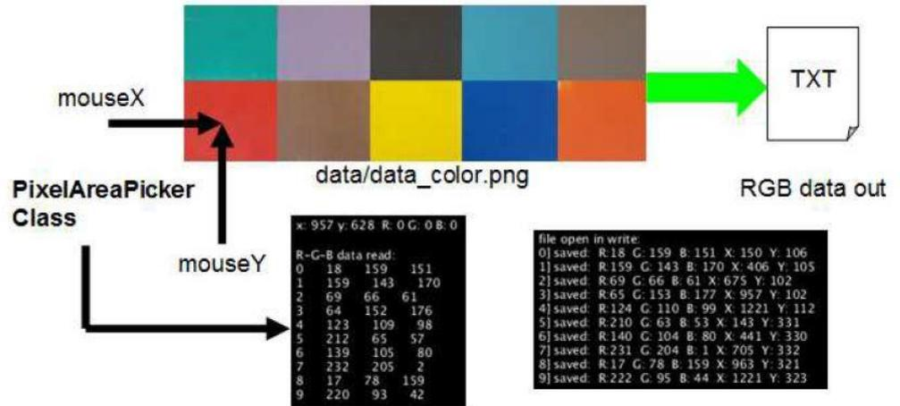
[Fig. 8 – Color pixel scanner per ricavare il set di dati RGB XY in un file .txt di output]
